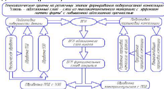
Рисунок 1 - Технологическая схема формирования покрытий из многокомпонентных материалов с эффектом памяти формы с повышенной адгезионной прочностью
