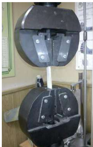
Рисунок 5 - Испытание на растяжение на разрывной машине ИР-5047-50
