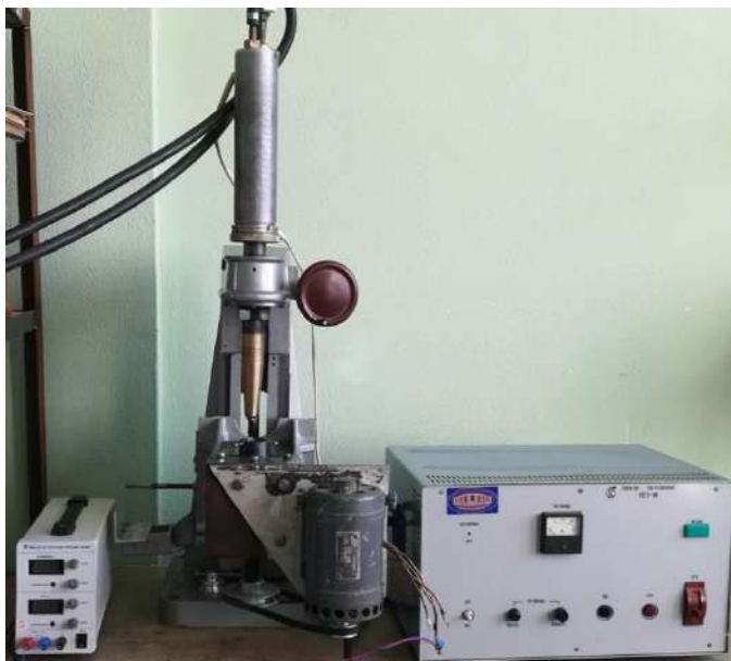
Рисунок 1 - Установка по обработке плоских тел с вращением.
